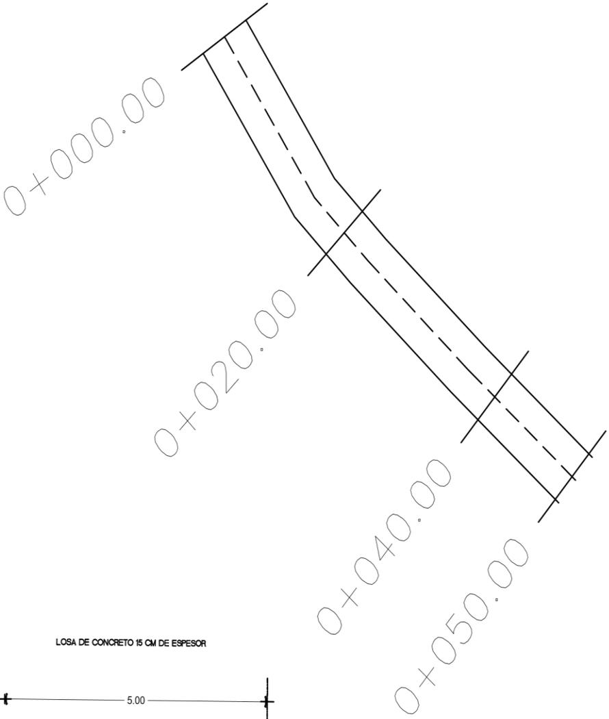
LOSA DE CONCRETO 15 CM DE ESPESOR
